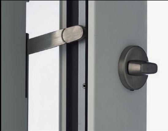
Die Türsperre TSH dient als Öffnungsbegrenzung. Sie wird außen über das Hauptschloss betätigt (kein Zylinder außen). Die Betätigung innen erfolgt über einen Drehknopf.
